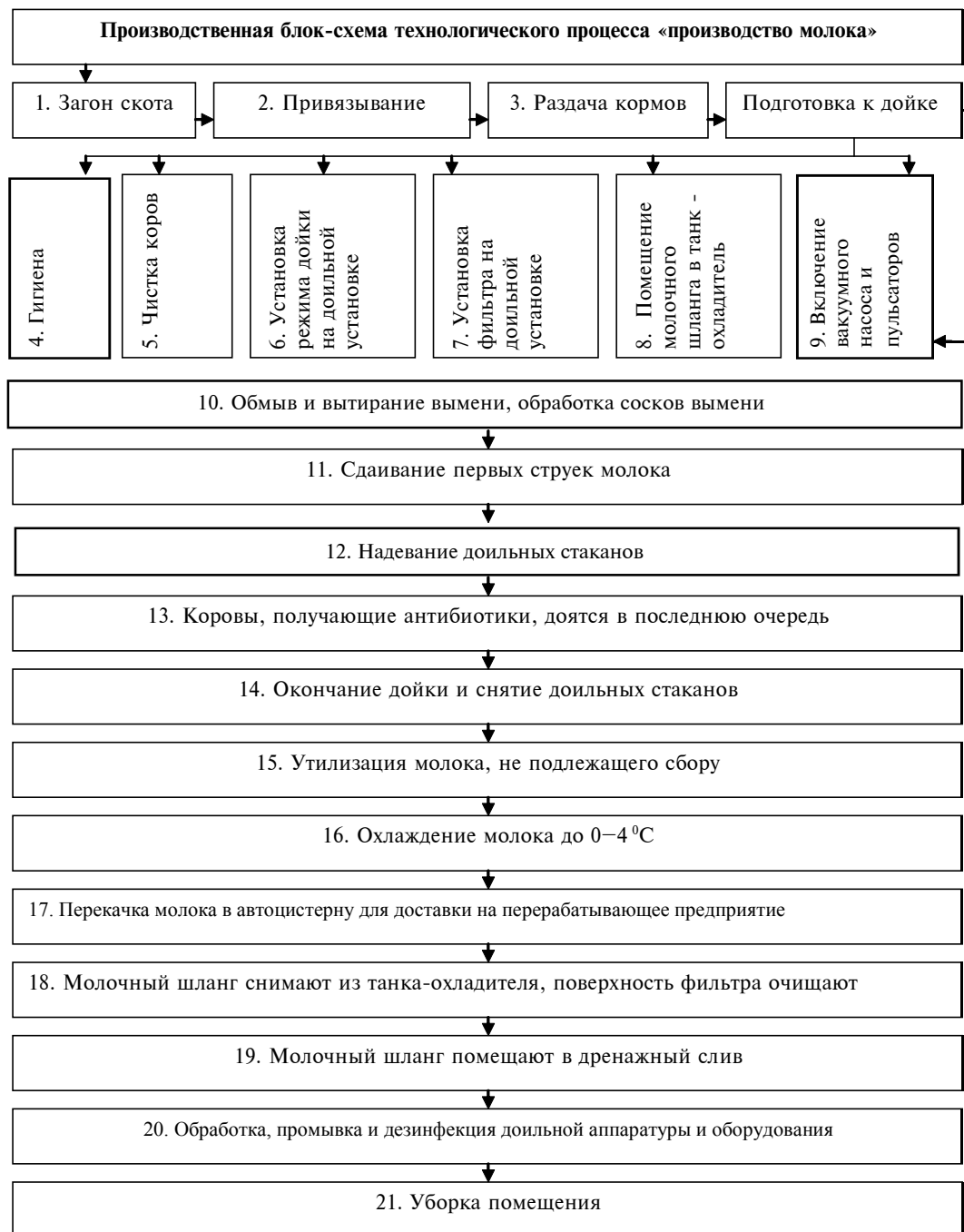
Рис. Производственная блок-схема технологического процесса «производство молока»
