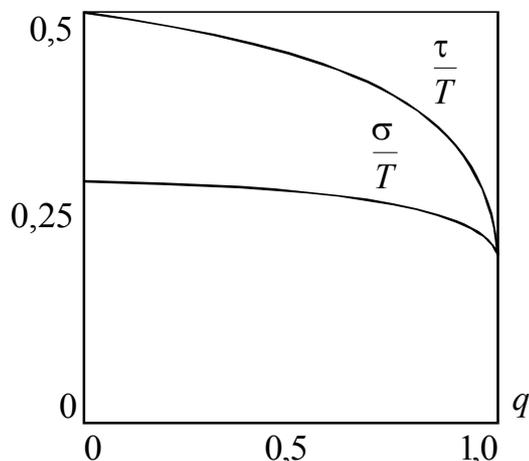
Рис. 1. Графики зависимости нормированного среднего времени задержки и нормированного среднего квадратичного отклонения времени задержки
